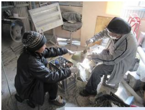
手作業でのFRP積層
